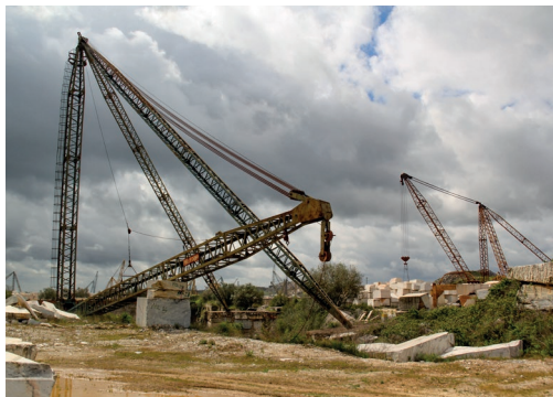
16. Gruas Derrick, pedreira de mármore na região de Extremoz e Vila Viçosa| CECHAP | PHIM
